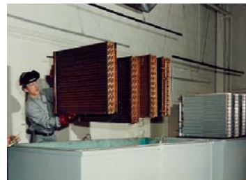
Proceso tipo Inmersión en la planta de Bronz-Glow
