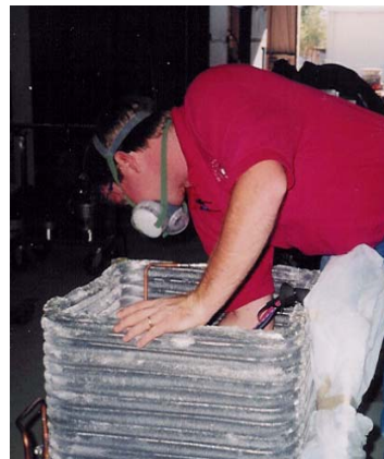
Aplicación tipo Aspersión en la planta de Bronz-Glow
