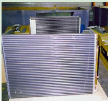
Evaporador revestido con Husky Sea Coast Transparente en el taller de un Contratista
